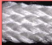
Struttura planare a nastro
