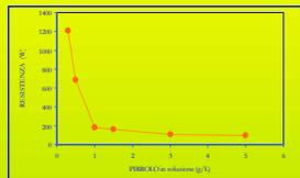
La resistenza del prodotto varia in funzione della quantità di pirrolo impiegato. Sono stati raggiunti valori di conducibilità paragonabili a quelli di materiali considerati conduttori.
